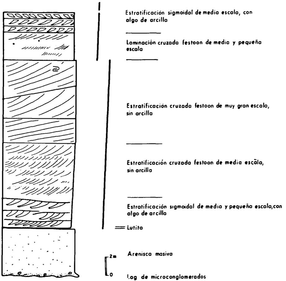
Fig. 2.- Secuencia básica del nivel biocalcarentítico superior.
